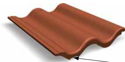
Bild 18. Spårpanna Palema, förproducerad spårpanna, inga urskärningar krävs. Urtaget är 5x35 mm.
