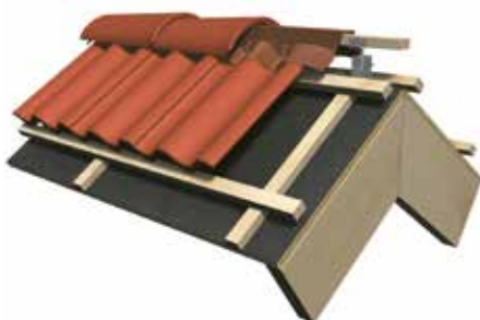
Bild 14. Benders nock och valmtättningsrulle är lätt att montera. Rulla ut en längd på nockplankan, spika eller häfta fast den. Ta sedan bort skyddstejpen på undersidan av rullen och tryck fast och forma mot takpannorna. Underlaget skall vara torrt och dammfritt och temperaturen bör vara minst +8°.
