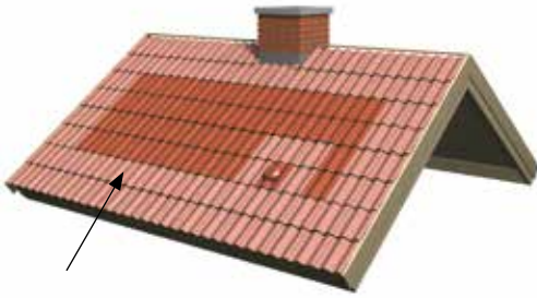
Bild 10. Infästningsmönster för spik och skruv, där de ljusst markerade pannorna alltid fästes.
