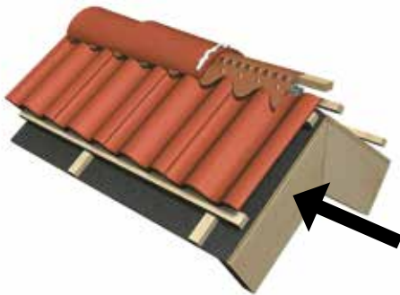
Bild 13. Ventilation av traditionellt papptäckta tak med slutna noken. Benders ventinock är spikad på nockbrädan och tätar mot inblåsande av regn och snö. Samtidigt medges luftcirkulation under takpannorna. Torra tak ruttnar inte! Nockpannorna läggs mot vindriktningen, se pil. Täta och skruva allt spika.
