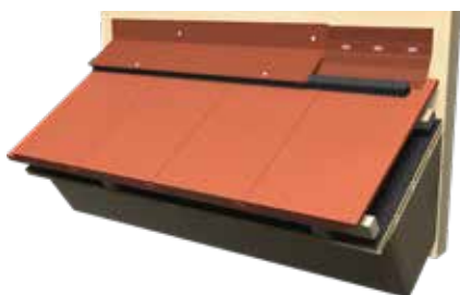
Bild 7: Exempel på luftning vid vägganslutning.
